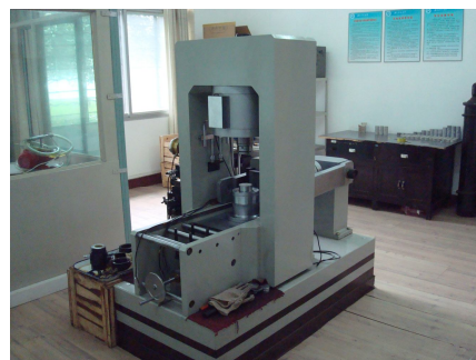
图 1 RMT-150C 试验系统 Fig.1 RMT-150C testing machine
